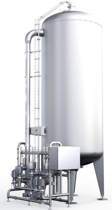
Standard-Modul mit Sitzventilen
