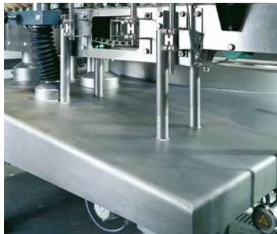
Ejecución con mesa Roof-Table
