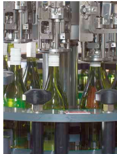
Conformación de la rosca de los tapones en las botellas
