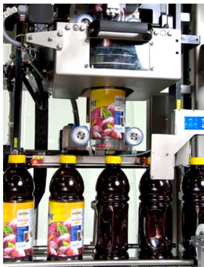
Entrega de sleeves en la Sleevematic M
