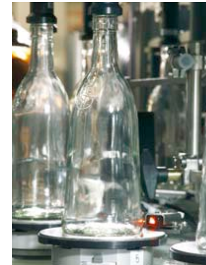
Orientación mecánica de los envases según la muesca en la pared (foto a la izquierda)
