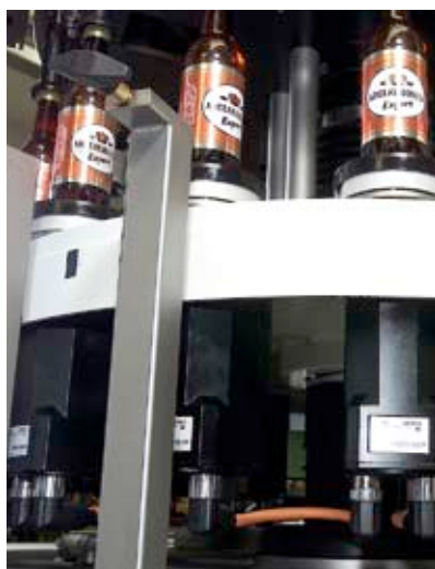
Mesa portaenvases con servomotores, tipo de protección IP65
