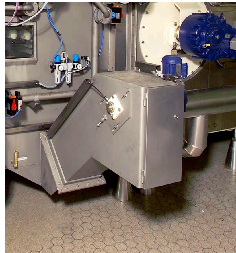
Extracción de vidrio roto
