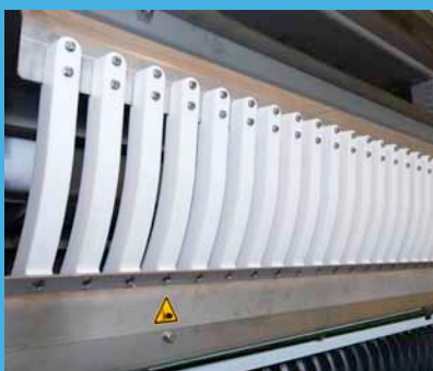
Resbaladera de botellas abierta fabricada con perfiles de plástico
