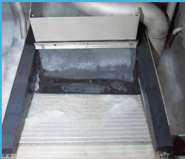
Extracción automática de suciedad
