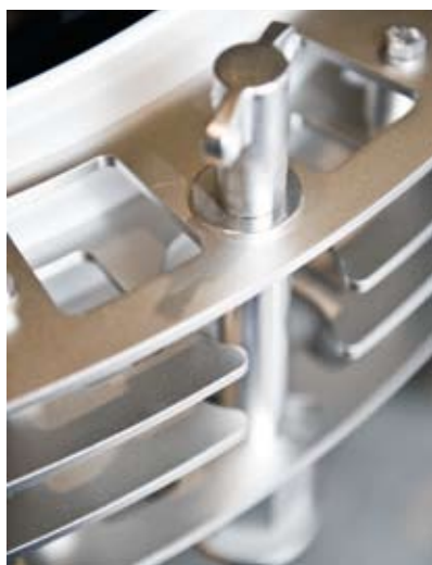
Estrella de guiado con sistema de bloqueo rápido (foto superior)
