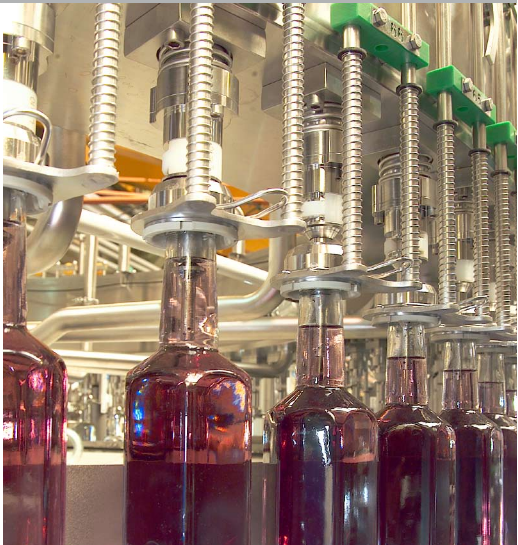
Sistema de llenado por vacío para bebidas espirituosas en botellas de forma especial
