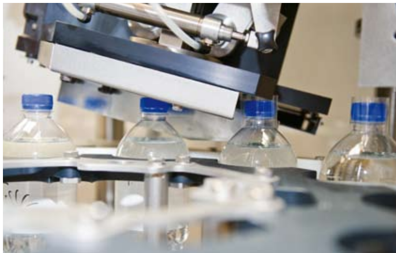
Aplicación del sleeve mediante conjunto Garantomat
