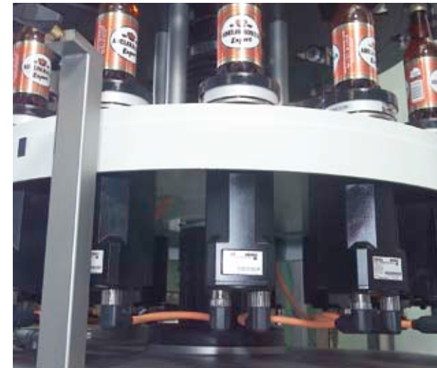
Mesa portaenvases con servomando para decoraciones especiales
