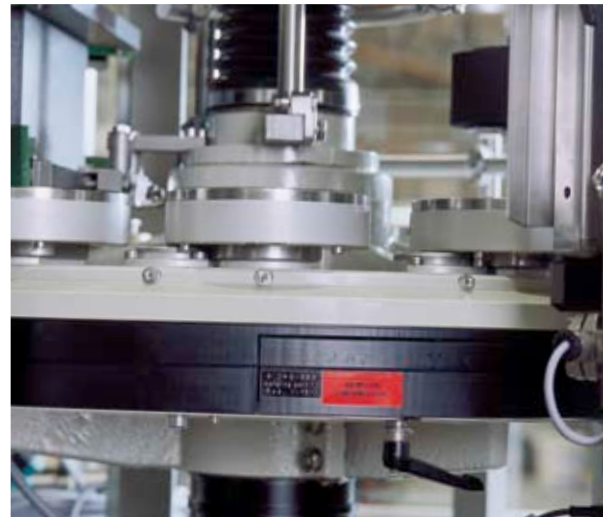
Mesa portaenvases con mando mecánico para envases de forma especial
