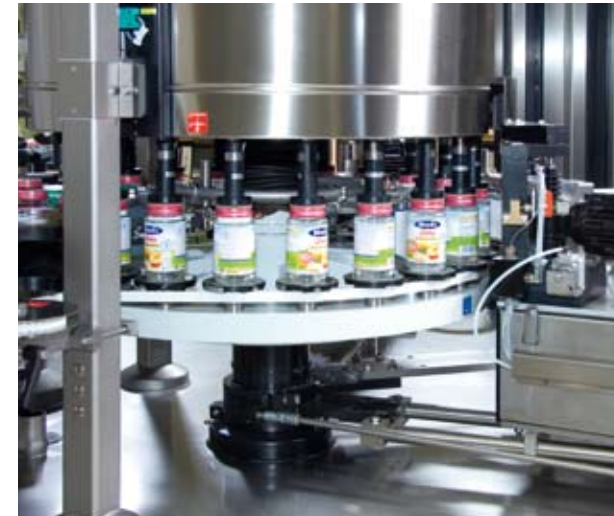
Giro de los envases mediante portaenvases con servomotores (foto a la izquierda)
