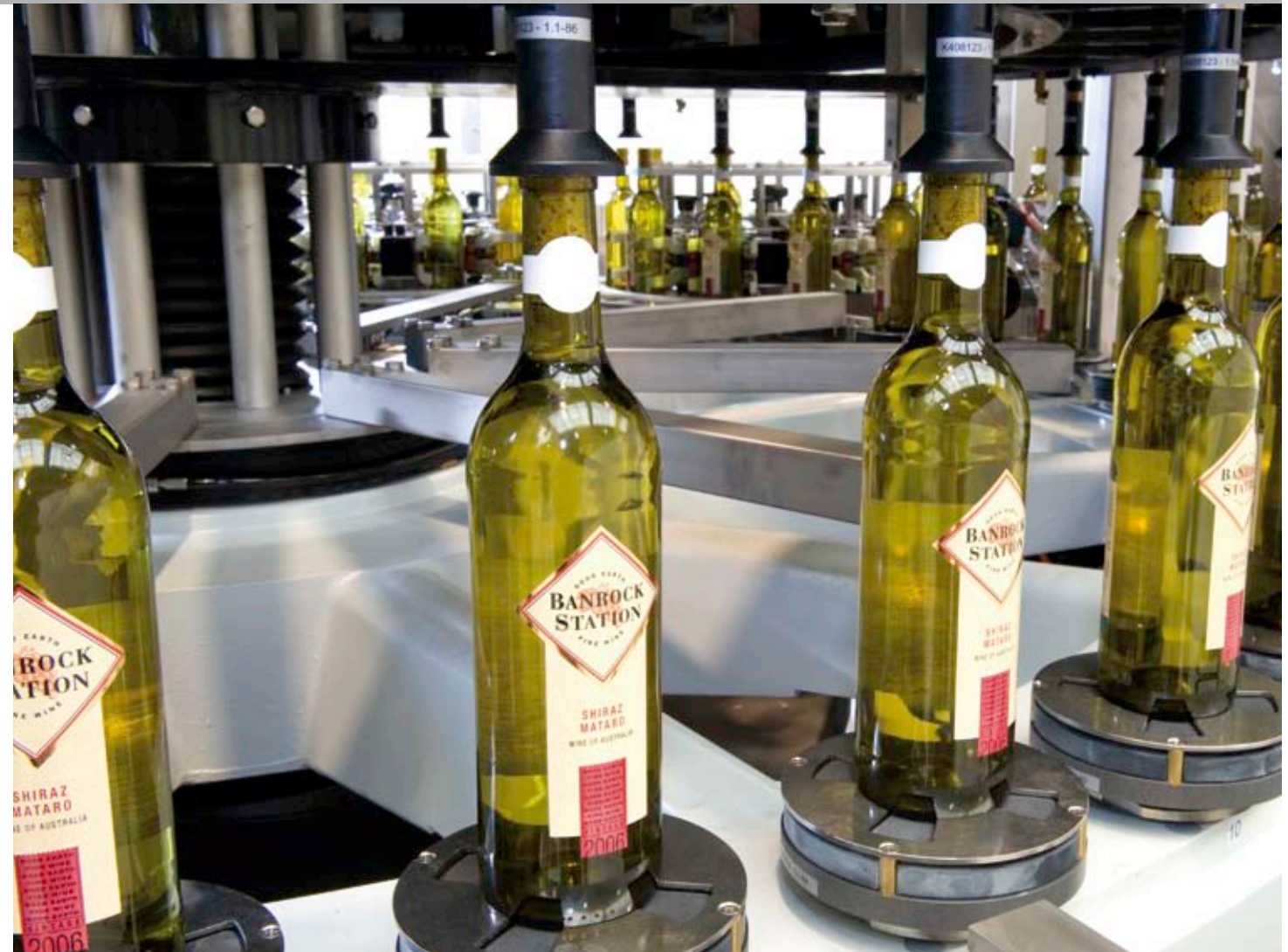
Mesa portaenvases mandada por servomotor y de construcción abierta
