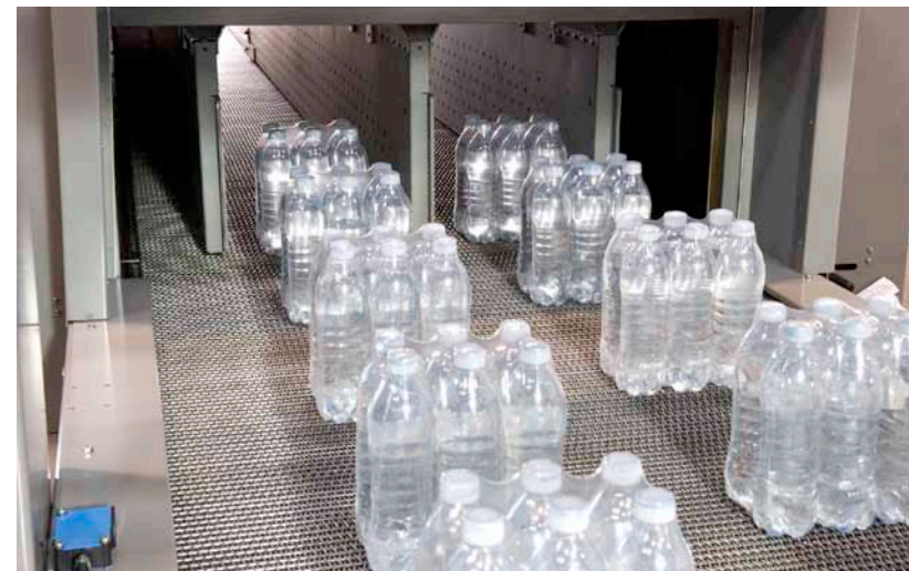
Los embalajes terminados salen del túnel de retractilado
